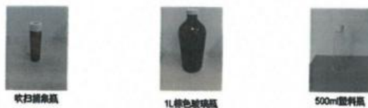
图 9 土壤和地下水采样容器
