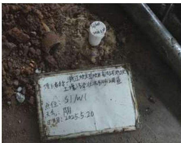
图 5.1-2 现场成井照片
