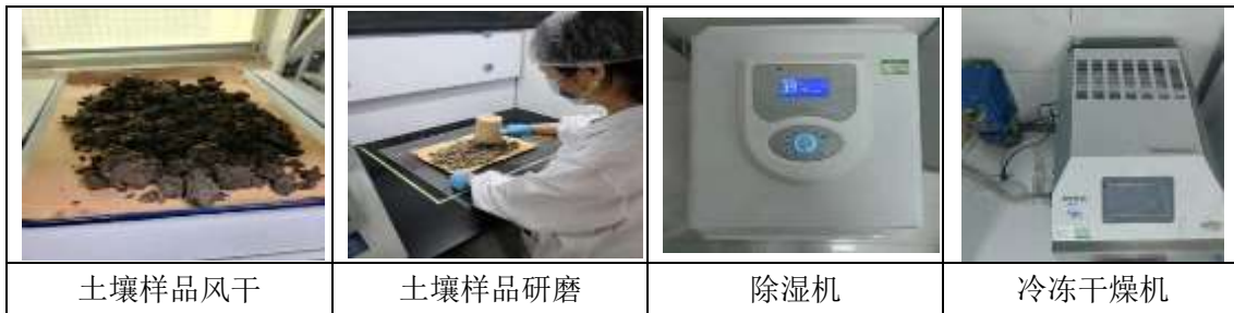
图 5.3-1 土壤样品制备照片
