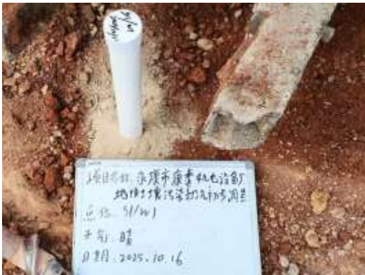
图 5-2 现场成井照片
