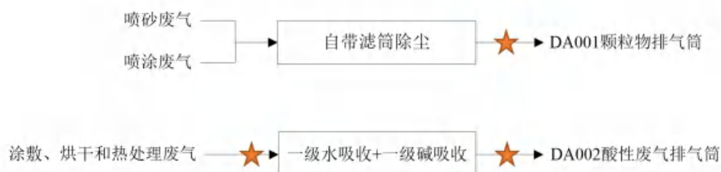
图 6-1 废气处理设施采样点位图
