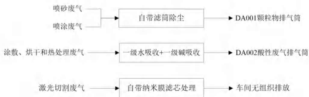
图 3-2 废气治理工艺流程图
