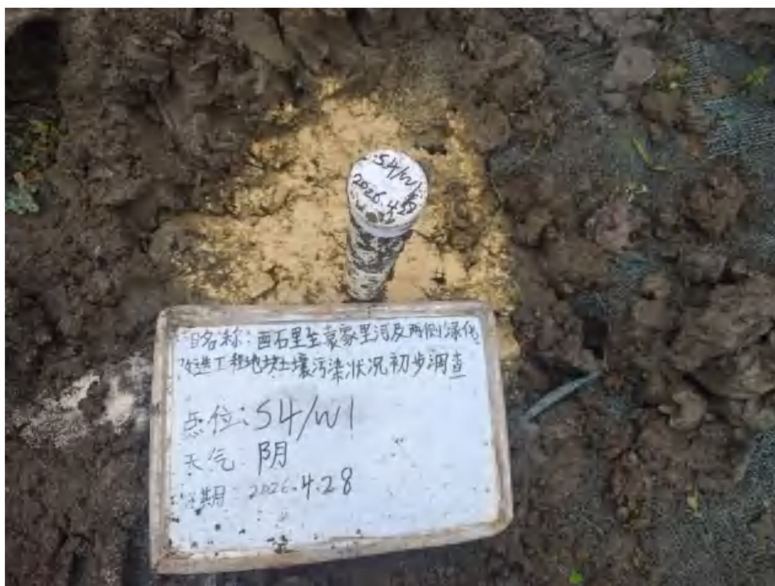
图 5-2 现场成井照片
