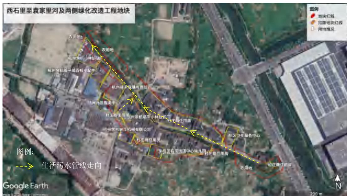
图 3-43 污水管网走向图
