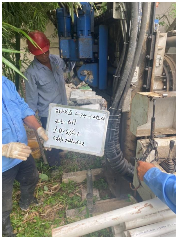
图 5-3 土壤采样钻探现场照片
