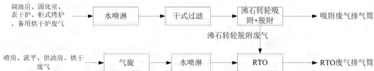
图 4.1.2-1 涂装线废气处理工艺流程
