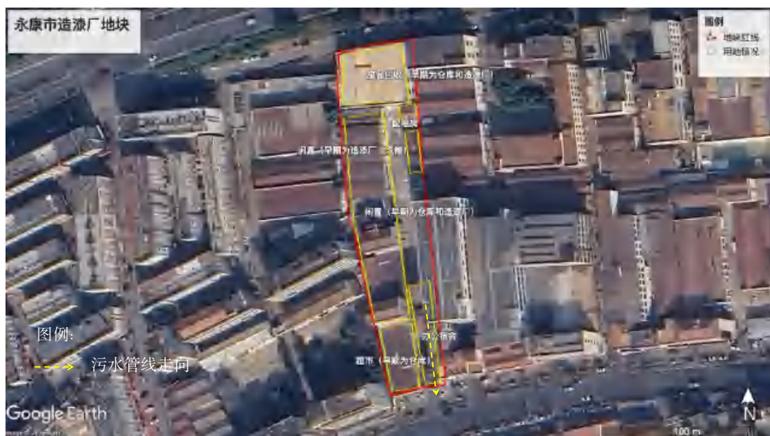
图 3-21 污水管网走向图
