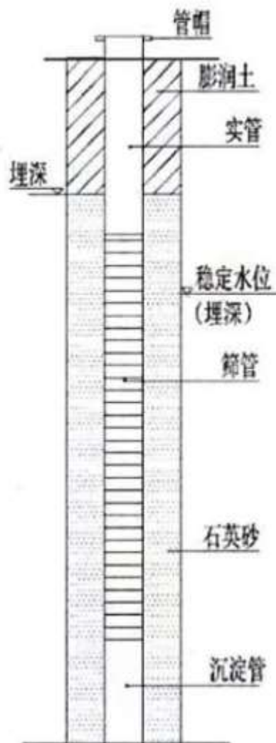
图 5.1-1 地下水采样示意图
