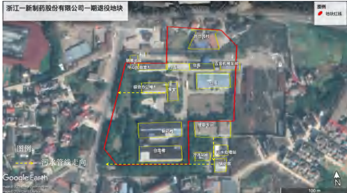
图 3-26 污水管网走向图
