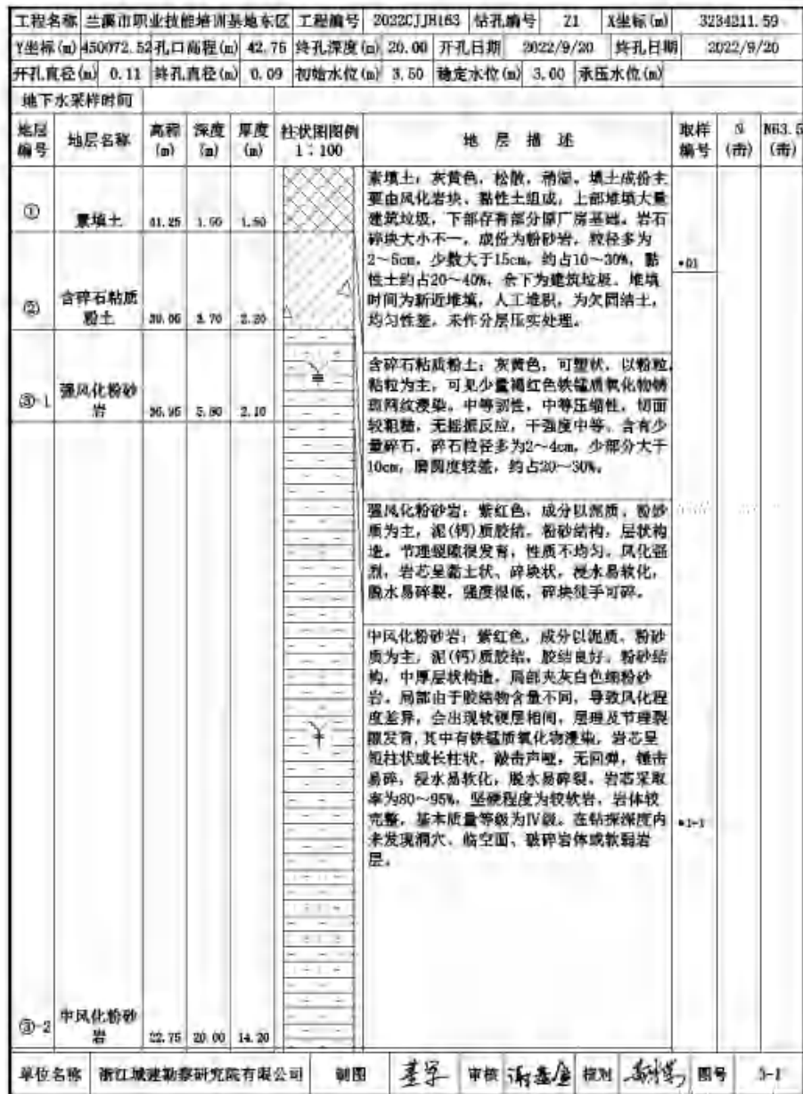
图 3-8 引用地勘地块内钻孔柱状图
