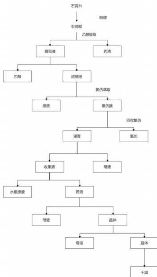
图 3-34 氢溴酸加兰他敏工艺流程图
