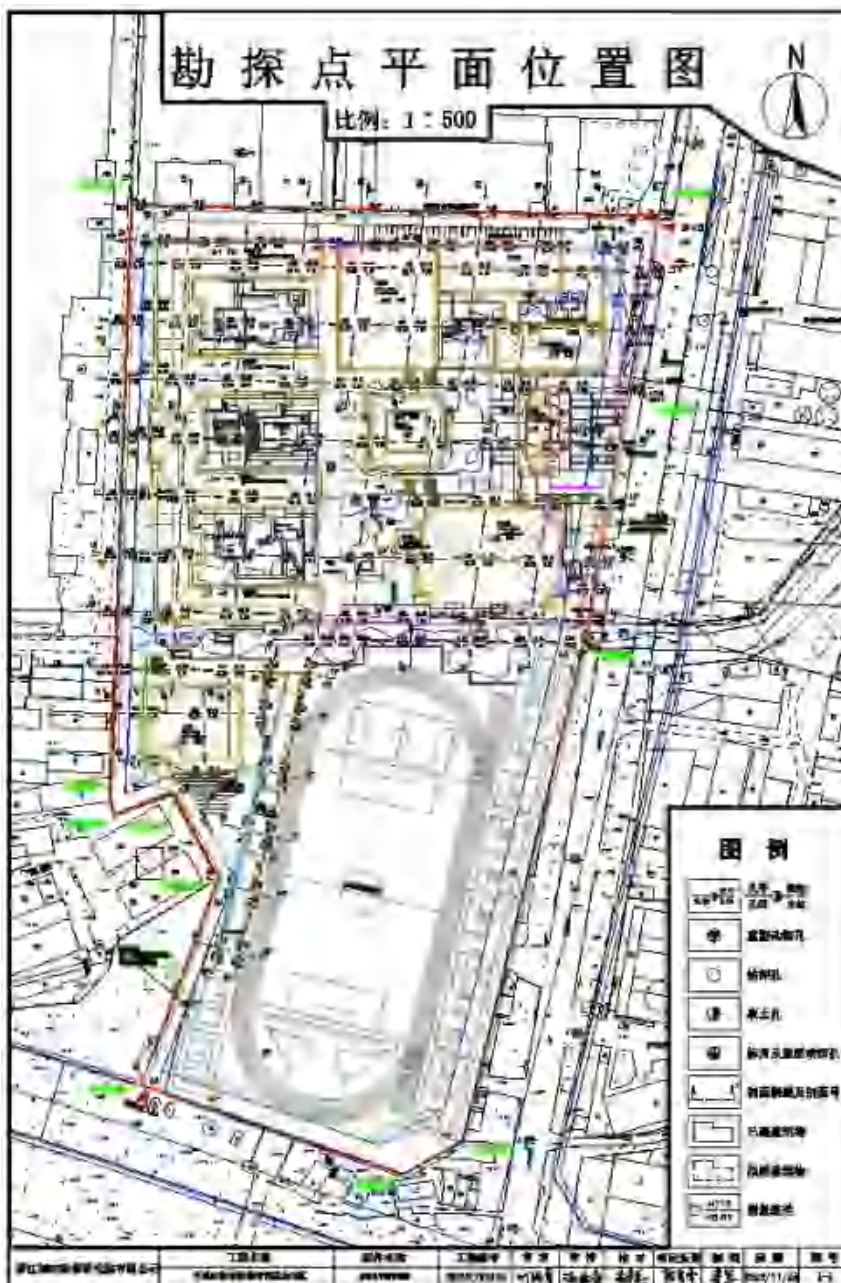
图 3-7 地勘地块勘探平面图
