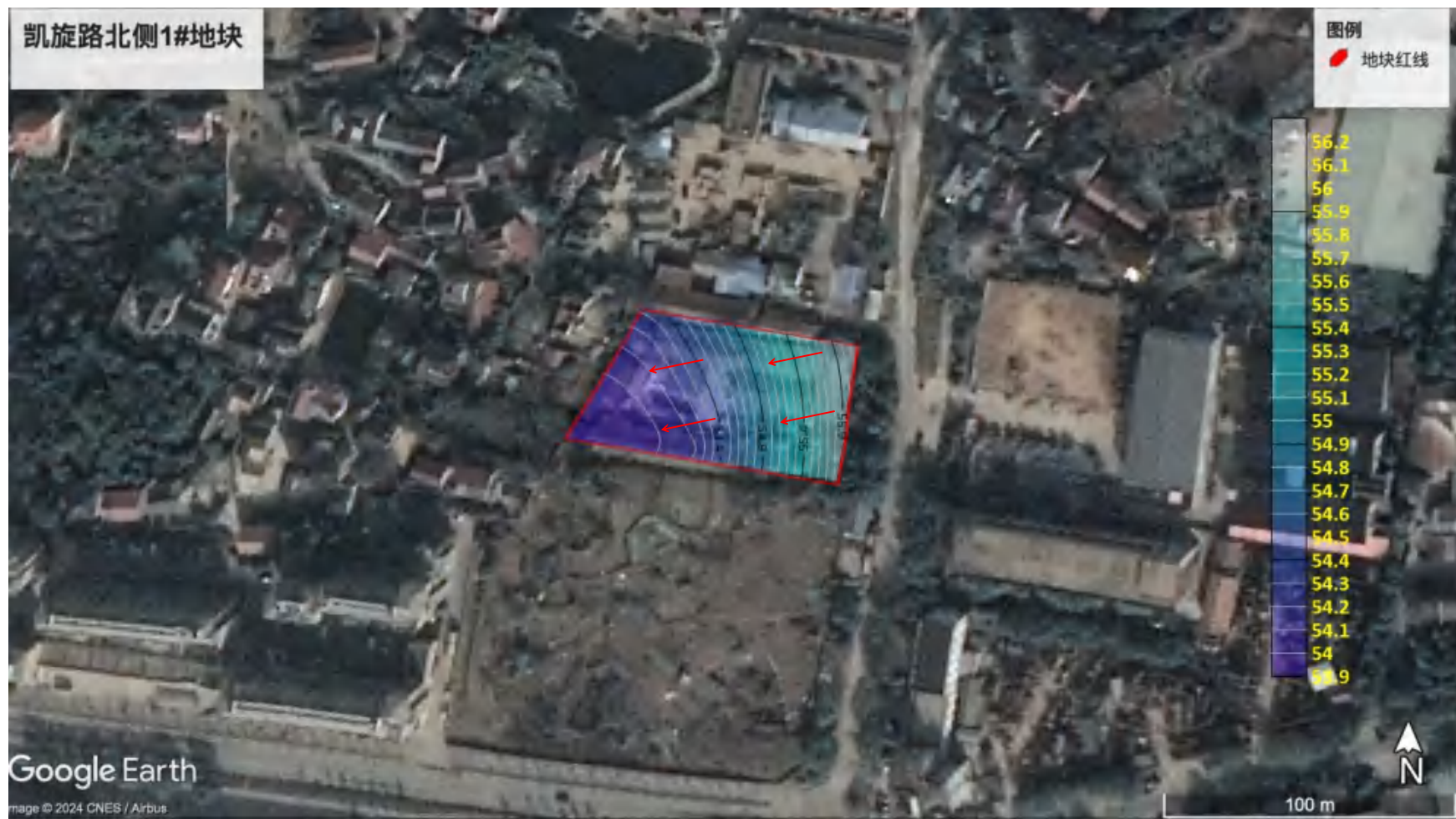
图 6-3 凯旋路北侧 1#地块地下水等位线图
