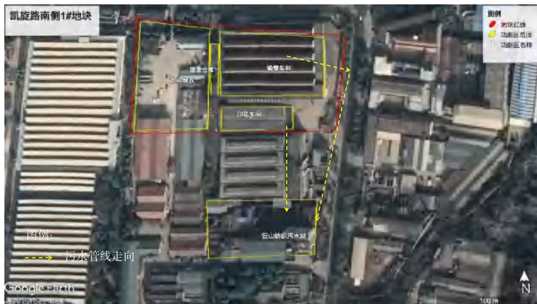
图 3-25 污水管网走向图
