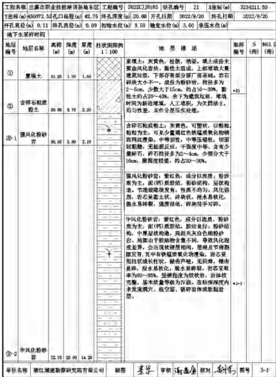
图 3-8 引用地勘地块内钻孔柱状图
