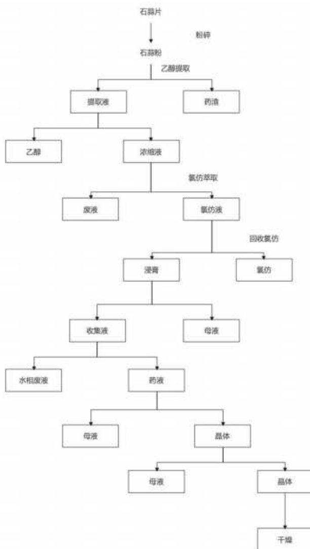
图 3-30 氢溴酸加兰他敏工艺流程图
