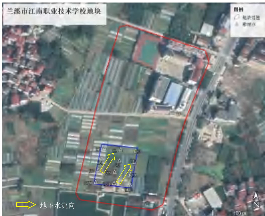
图 3-8 兰溪市上华片区 LX1101-20/21/22/48 地块地下水流向图
