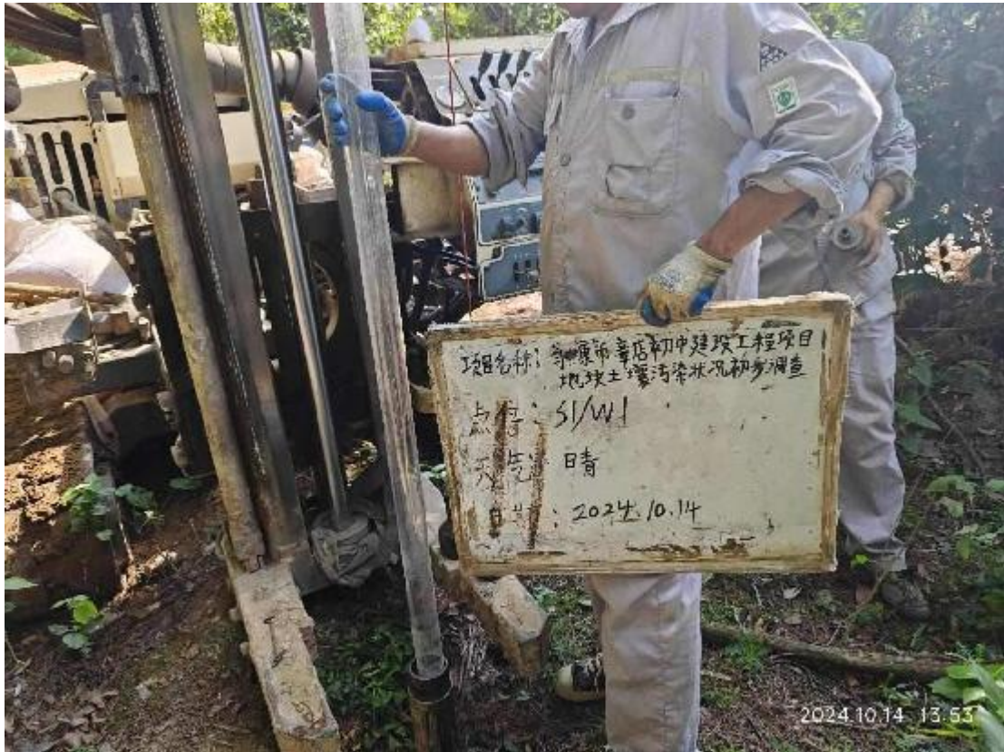
图 5-3 土壤采样钻探现场照片
