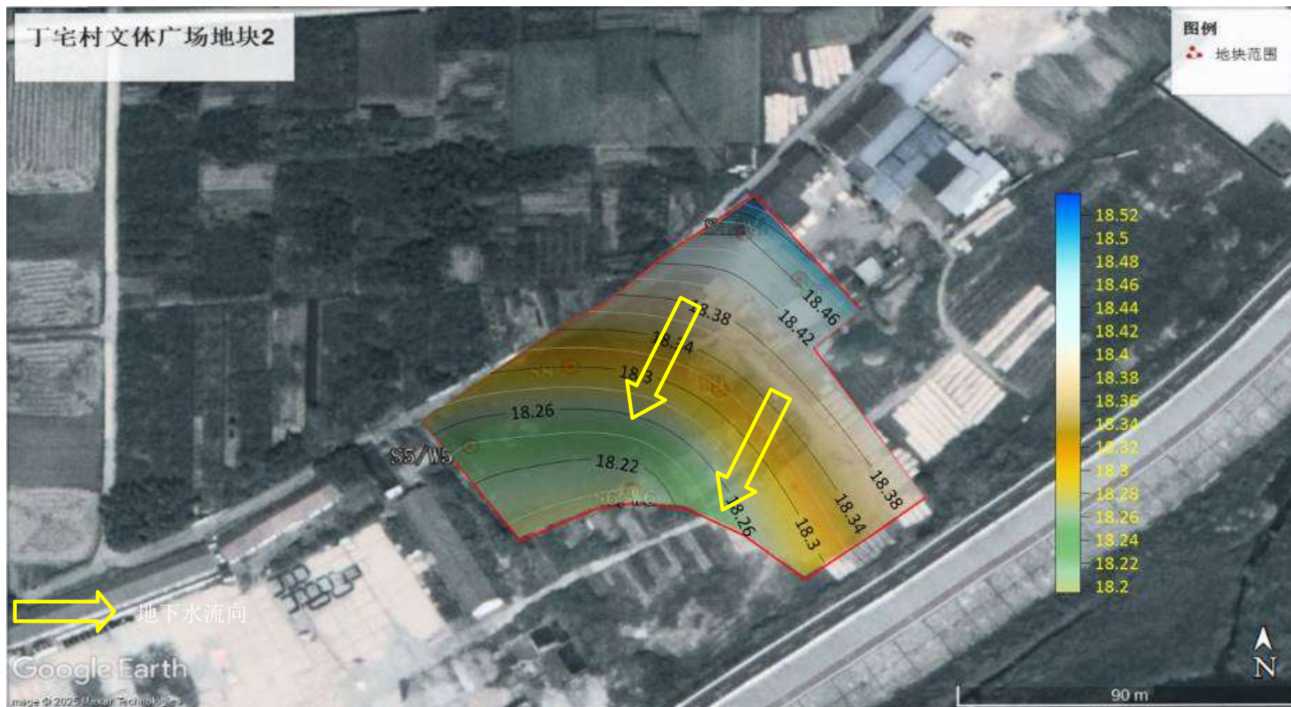
图 6.1-4 丁宅村文体广场地块 2 地下水等位线图
