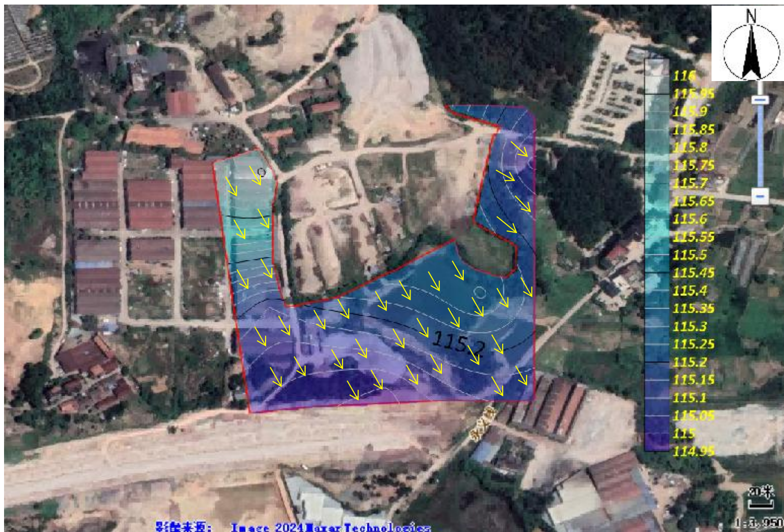
图 5-9 浙江省永康卫生学校迁建工程（地块二、三、四）地下水等位线图
