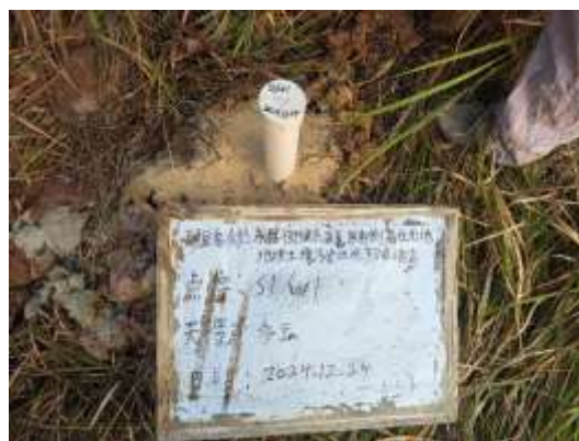
图 5-2 现场成井照片
