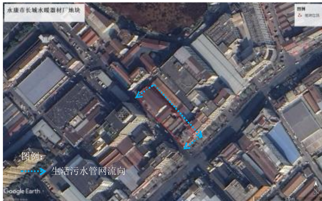
图 3-37 地块内企业污水排水管网图
