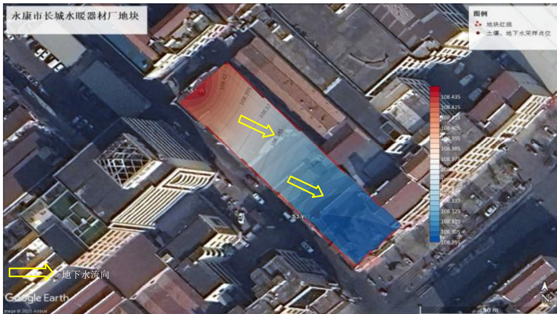
图 6-2 永康市长城水暖器材厂地块地下水等位线图
