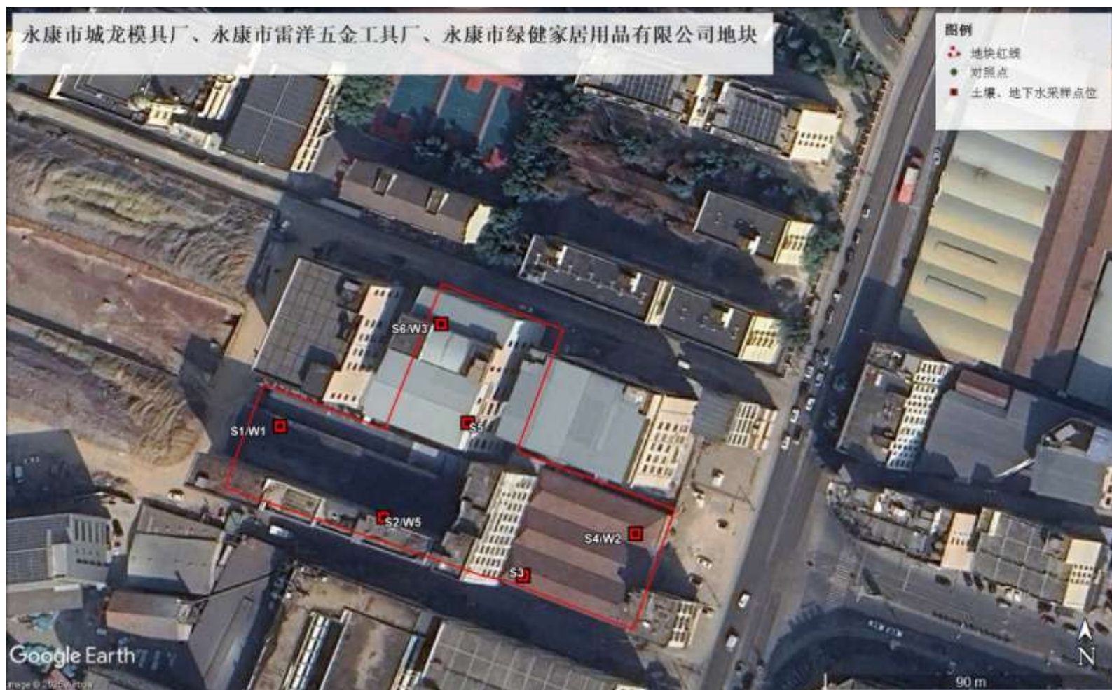
图 3-63 永康市城龙模具厂、永康市雷洋五金工具厂、永康市绿健家居用品有限公司地块采样布点图（不含对照点）
