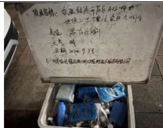
地下水样品运输
