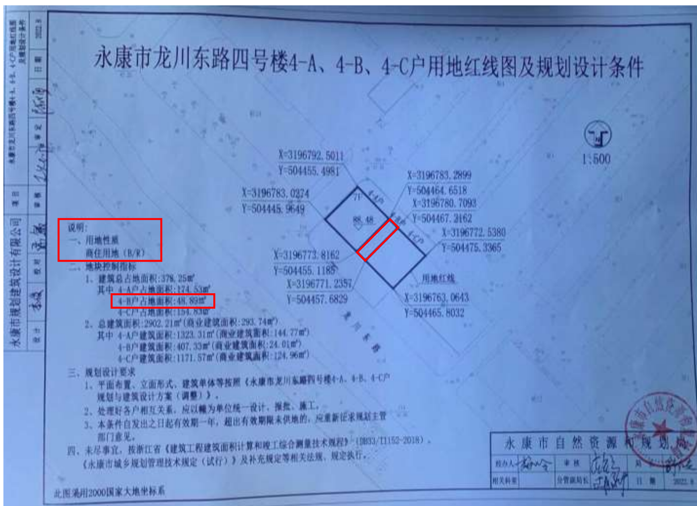
图3-15 永康市龙川东路四号楼4-A、4-B、4-C户用地红线图及规划设计条件
