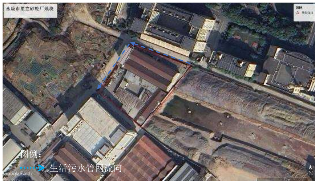
图 3-50 地块内企业污水排水管网图
