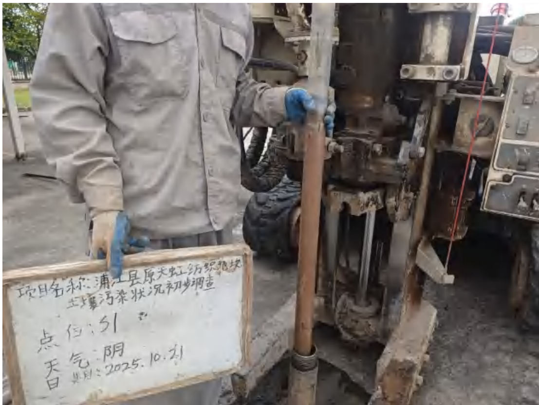
图 5-3 土壤采样钻探现场照片
