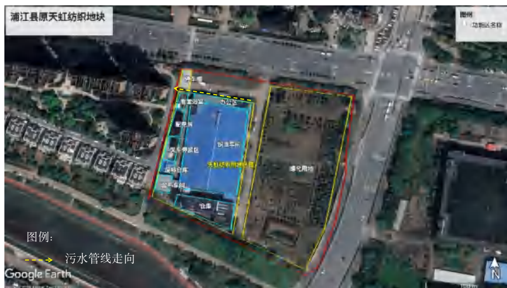
图 3-23 污水管网走向图
