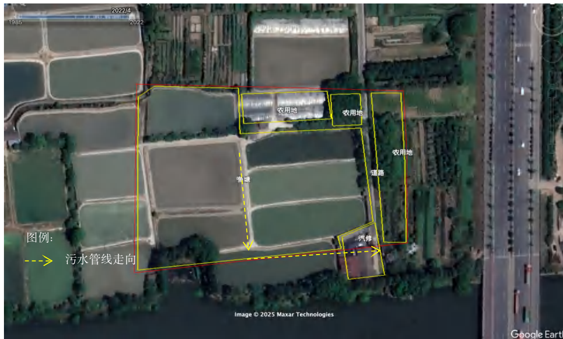
图 3-20 污水管网走向图
