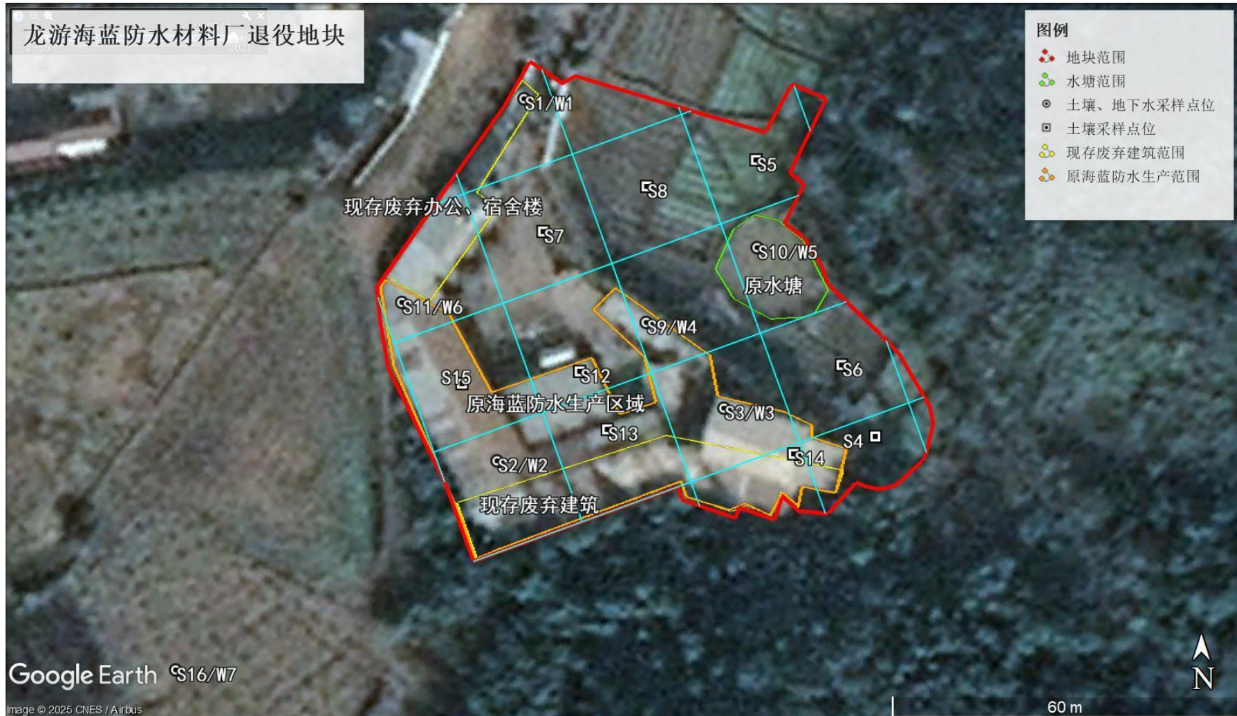
图 5-7 地块实际采样布点图（采样点位均位于潜在污染区域内）
